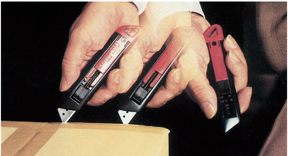
Bild 5: Allein das Schneidgut hält die Klinge gegen die Kraft der Zugfeder in Schneidstellung. Beim Verlassen des Schneidgutes schnellt die Klinge augenblicklich in Schutzstellung zurück.
