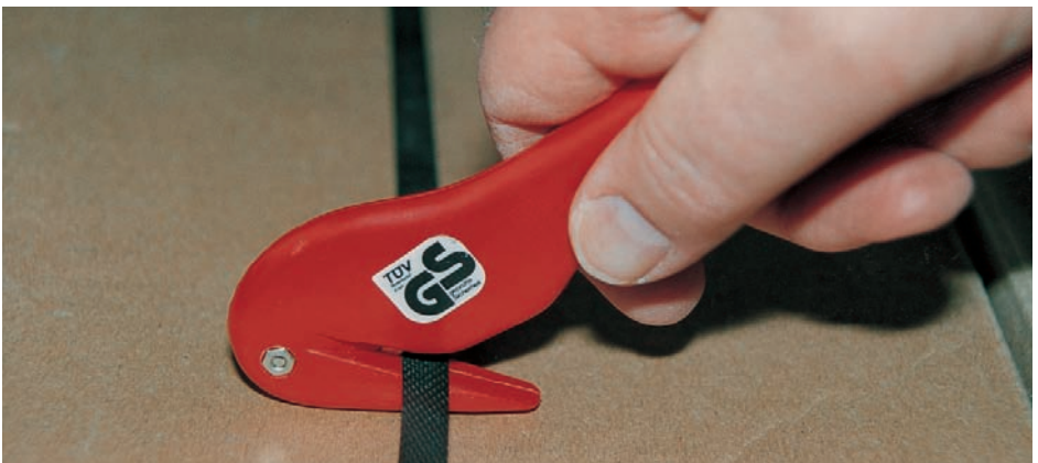
Bild 11: Folienschneider/Folienmesser zum Schneiden einer Bandverschnürung.
